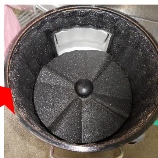
球根皮むき機の中の刃の様子
